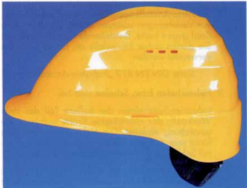
Bild 2: Industrieschutzhelm mit heruntergezogenem Nackenteil, Belüftungsöffnungen und seitlichen Schlitzern zur Befestigung von Zubehör (z.B. Gehörschützer), jedoch ohne Regenrinne
